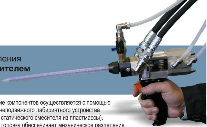
Перемешивание компонентов осуществляется с помощью специального неподвижного лабиринтного устройства (одноразового статического смесителя из пластмассы). Смесительная головка обеспечивает механическое разделение двух потоков компонентов вплоть до статического смесителя, а значит, отпадает необходимость в системе промывки.
