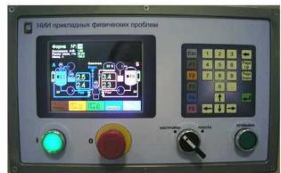
Дозатор на базе высокоточных химическистойких шестеренных насосов с раздельным приводом и обратной связью.
