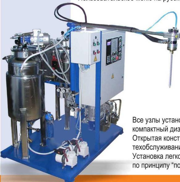
Все узлы установки смонтированы на общей раме, обеспечивая компактный дизайн и возможность размещения в небольшом помещении. Открытая конструкция обеспечивает доступ со всех сторон для техобслуживания и чистки узлов.
